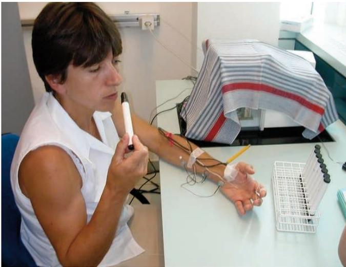
Capteurs permettant de mesurer l'activité du Système Nerveux Autonome (SNA) positionnés sur la paume de la main, lors d'une expérience olfactive.
