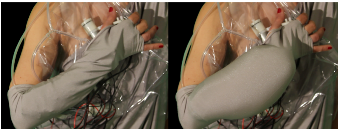
Fig. 2. D tail d'une poche situ e au niveau d'un avant-bras et dont le volume est contr l  par un syst me pneumatique
